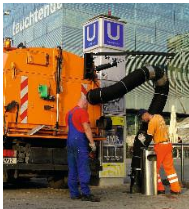
Der unterirdische Müllbehälter in der Königstraße wird geleert.
