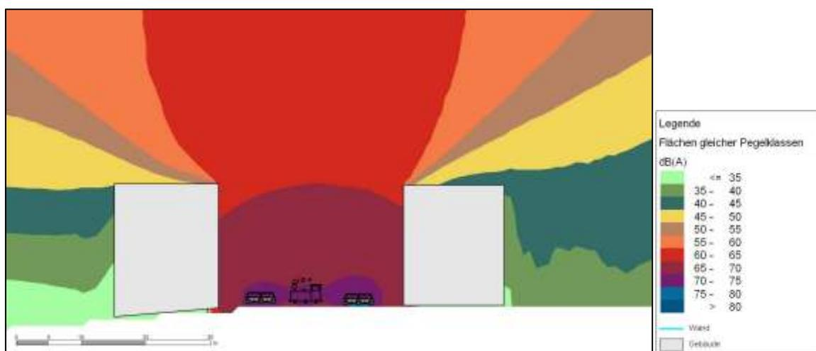
Abbildung B 3: Pegelverteilung (Schnitt) tagsüber in dB(A) mit lärmindernden Fahr-
