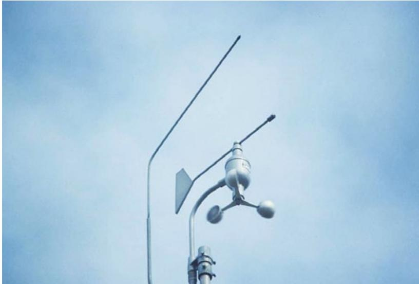
Abb. 3/25 Windmesser (Schalenstern-Anemometer)
