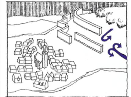
Abb. 6/23 Keine hangparallele Zeilenbebauung
