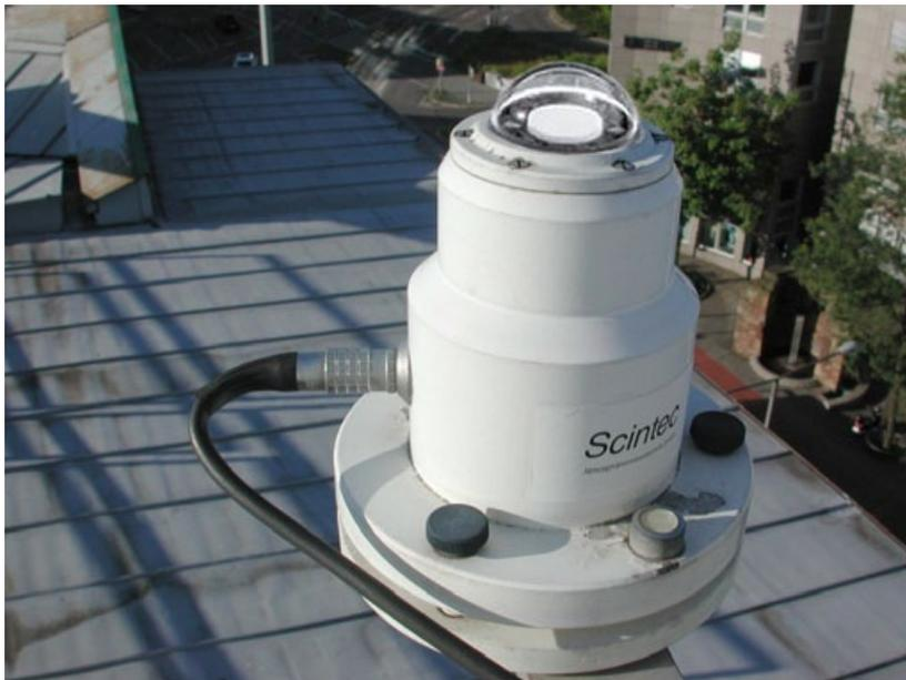
Abb. 3/2 Messgerät zur Erfassung der Globalstrahlung (UV-Anteil), Scintec AG, Rottenburg
