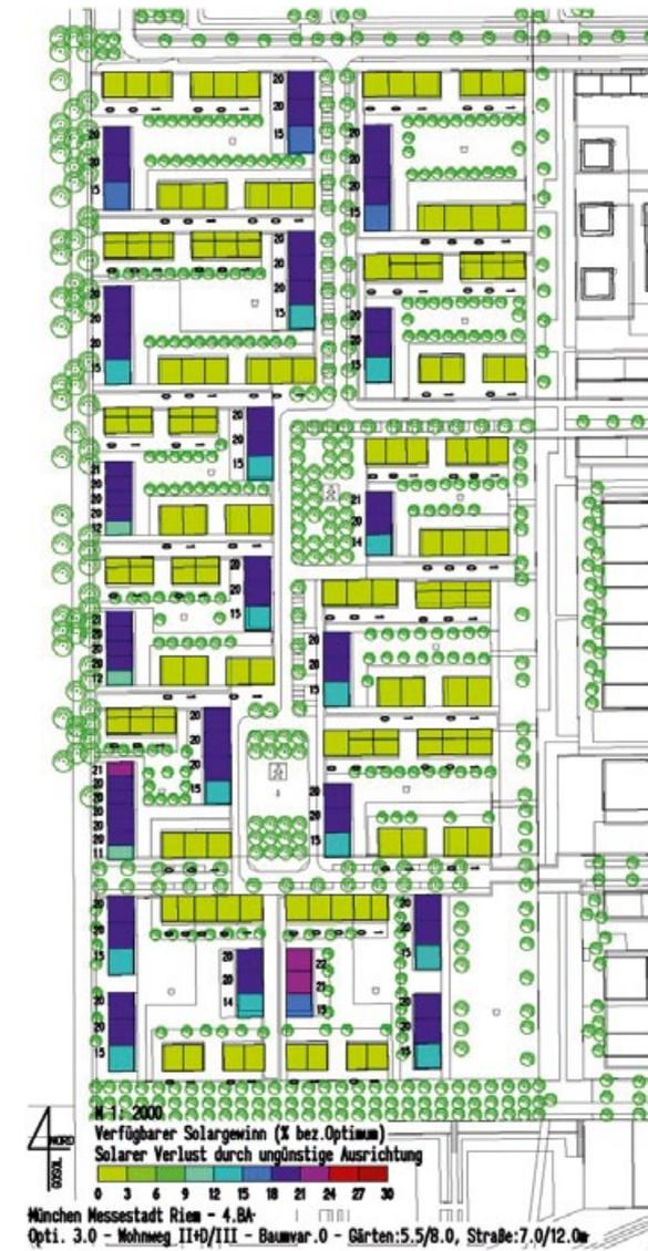
Abb. 3/18 Solarer Verlust durch ungünstige Gebäudeausrichtung, GORETZKI, 2012
