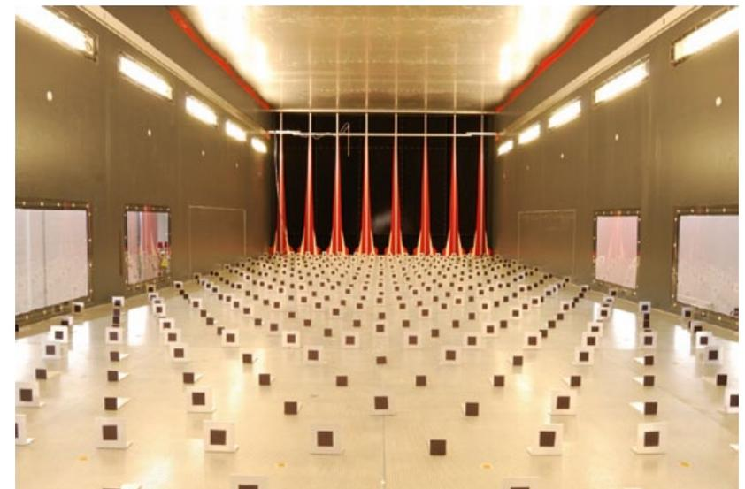
Abb. 4/7 Turbulenzgeneratoren und Rauigkeitselemente im Grenzschichtwindkanal Wotan, Quelle: UNIVERSITÄT HAMBURG, INSTITUT FÜR METEOROLOGIE
