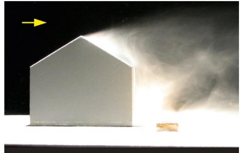
Abb. 4/10a Nachlaufzone eines Gebäudes im Windkanal, durch Rauch sichtbar gemacht, Quelle: INGENIEURBÜRO THEURER
