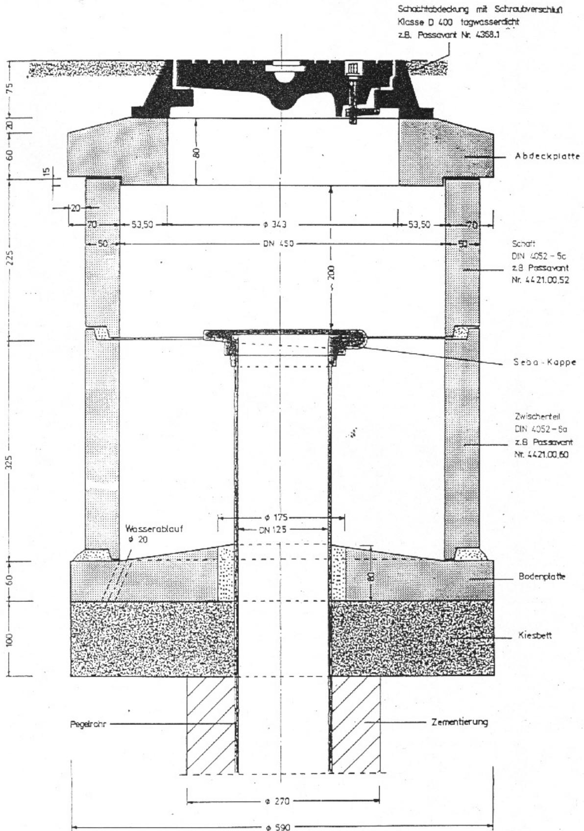
Pegelkopf für Grundwassermesspegel
