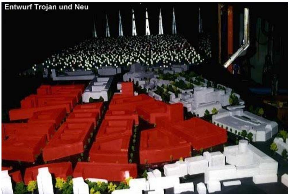
Abb. 3.3: Entwurf Trojan – Ansicht des Modells im Windkanal
