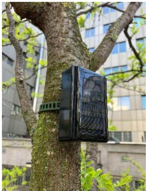
Abbildung 20: Bewässerungssensorik im Boden eines Baumquartiers (links) und in der Baumkrone (rechts), © LHS
