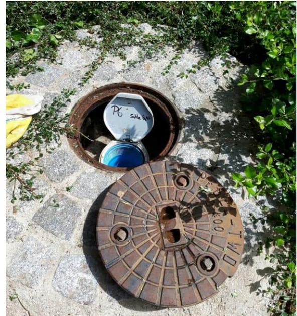
Abbildung 18: Eine Grundwassermessstelle vor Ort, © LHS
